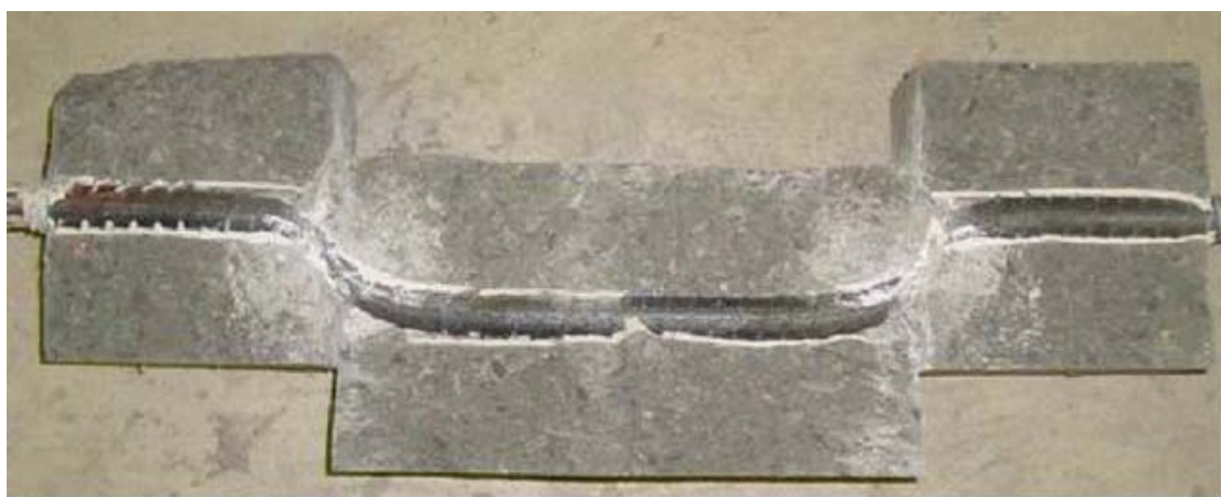
圖2.18 岩栓於模擬節理面行為中進行剪切的試驗(Hossein Jalalifar, 2009)
