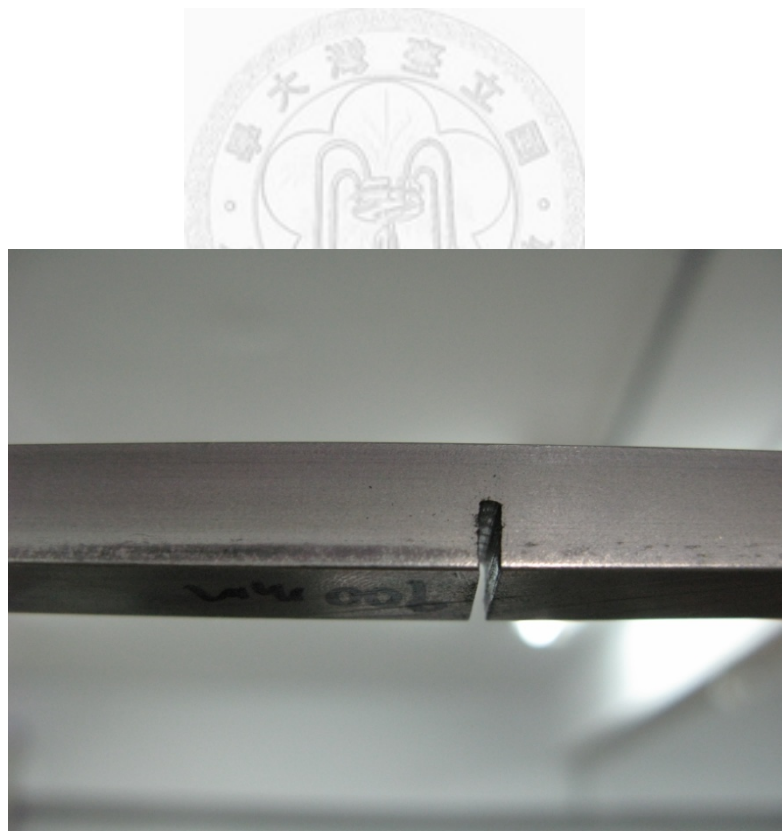
圖 4.13 樑之缺陷(transverse line crack)
