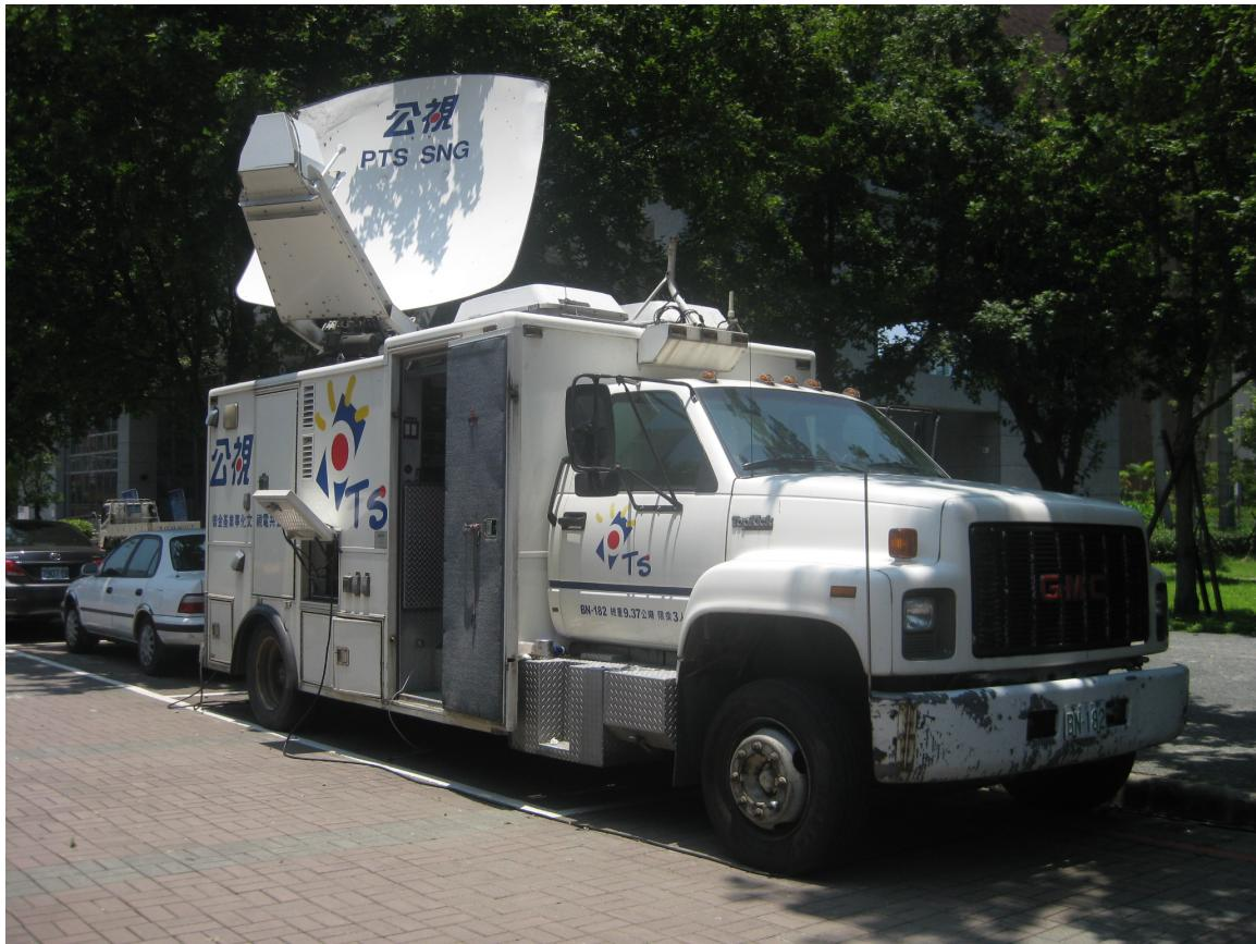
圖四：公視的老式 SNG 車，體型龐大，車長達一般轎車的三倍，車寬也近兩倍。研究者／攝影
