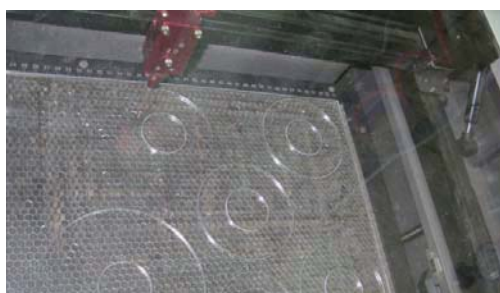
圖 6-6 雷射切割壓克力板過程
