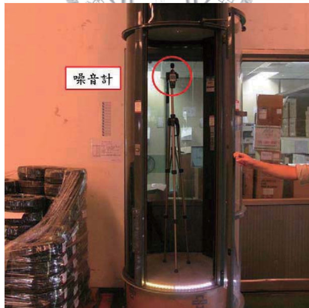
圖 3-2 梭體內噪音量測實驗情形示意圖
