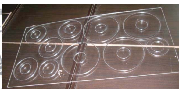
圖 6-7 雷射切割壓克力板完成品
