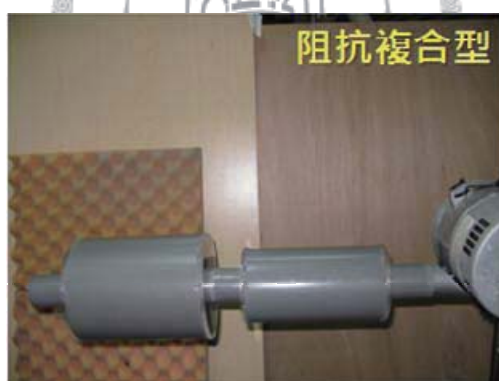
圖 6-15 阻抗複合型消音器實驗示意圖
