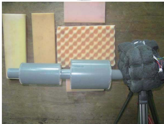
圖 6-17 外覆防音材之鼓風機與阻抗複合消音器示意圖
