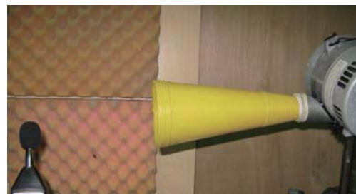
圖 4-9 漸擴管噪音量測實驗示意圖
