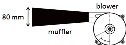
圖 4-8 漸擴管幾何尺寸示意圖
