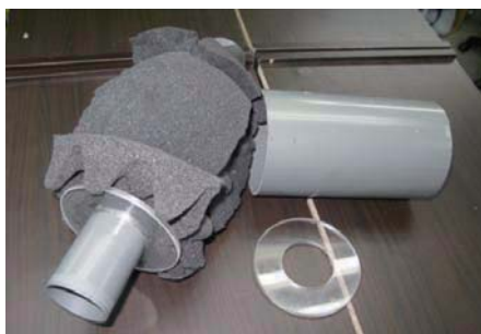
圖 6-12 阻性消音器組裝過程
