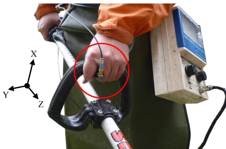
圖 3-10 軟管式割草機加速度計位置
