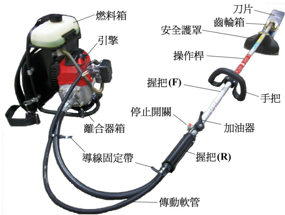
圖 3-1 軟管式割草機構造(葉，2010)
