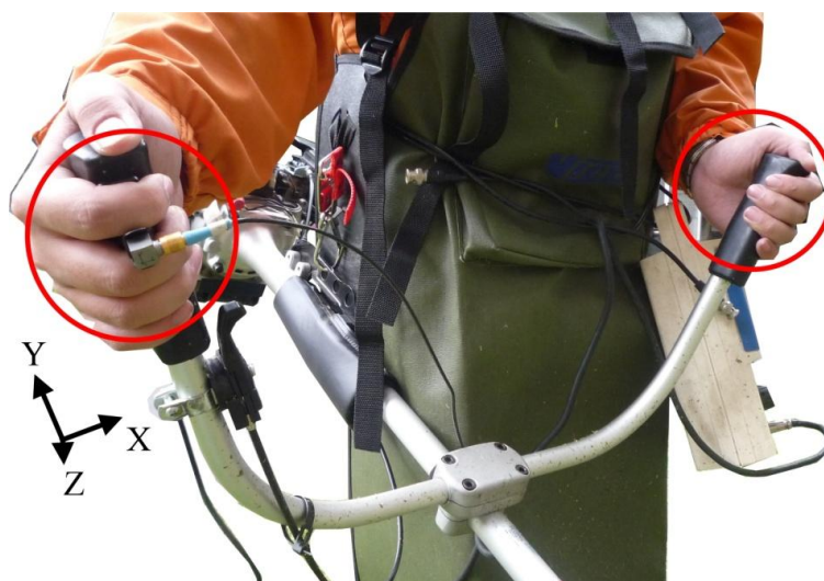
圖 3-11 硬管式割草機加速度計位置
