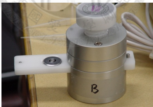
圖 4-4 使用 C-52 樣品水份測試箱量測甘藍苗葉片樣本之水份潛勢
