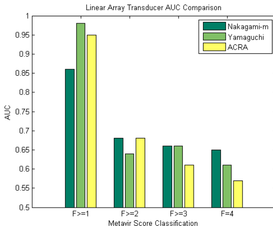
圖 5-1 臨床線性陣列探頭實驗三種方法之 AUC 比較圖
