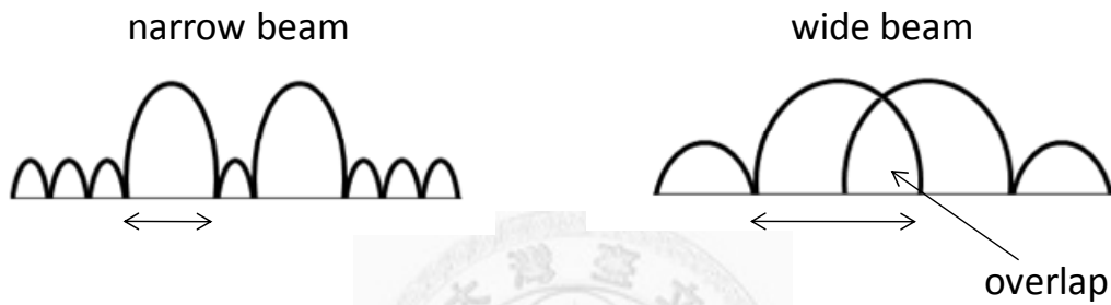
圖 2-10 超音波音束之側向寬度的示意圖
