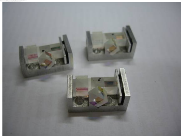
圖 2-4.3 VIM 機械夾持具設計圖與實體照片
