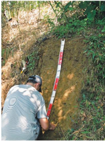
圖1 挖掘土壤剖面到 C 層或岩層，未能挖至 C 層或岩層者至少需挖120公分深度(杜清澤 攝)
