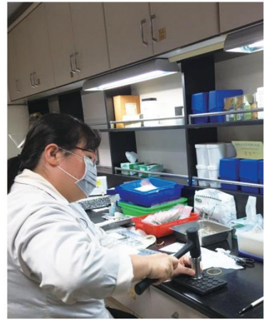
圖3 樣本經前處理及風乾磨粉後壓錠以備進行碳、氮百分組成測定(杜清澤 攝)
