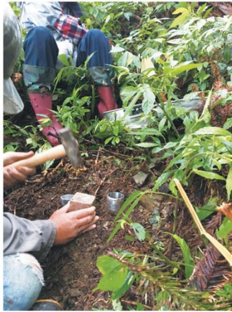
圖2 利用土罐法採取3-5個土壤樣本進行土壤容積測定(杜清澤 攝)
