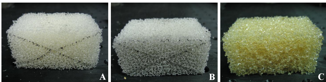
圖 2- 4 A : Open Cell 5.5 pcf B : Open Cell 7.5 pcf C : Cellular 7.5 pcf
