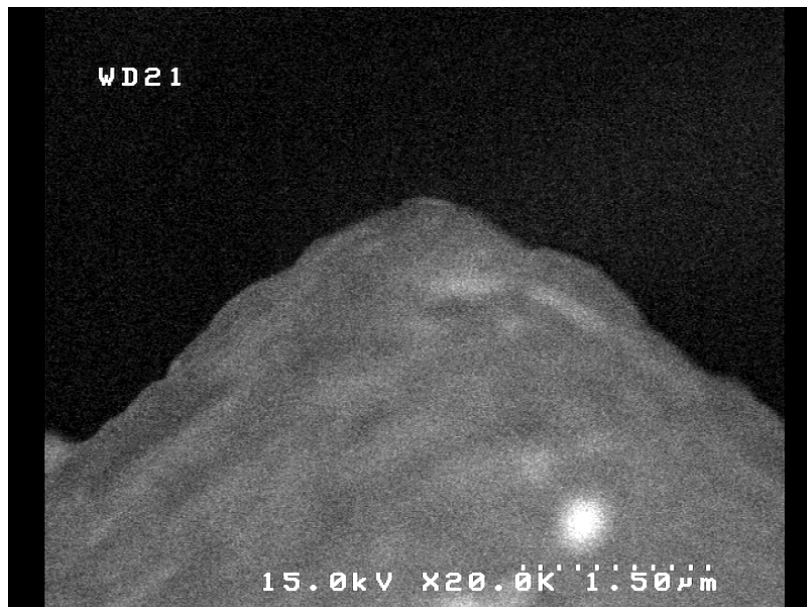
圖 3-13 刀輪尖端之 SEM 照片。
