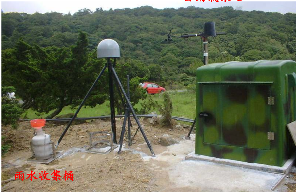
圖 3-3 陽明山採樣站之雨水收集桶及自動氣象站
