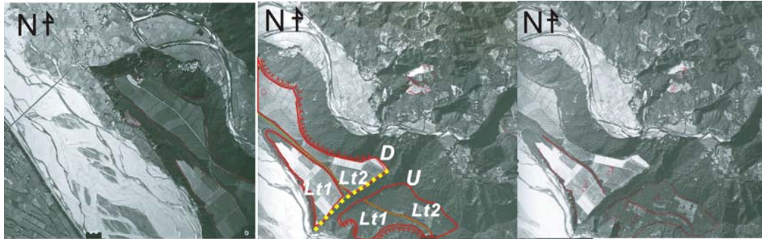
圖十一：枕頭山線型航空照片立體像對（從左至右）：67P76-179，67P75-420，67P75-423）。可以判釋出枕頭山線性崖截切（黃色線段）階地面（紅色線段），且發現於 Lt2 階地面邊緣有大型山崩事件。
