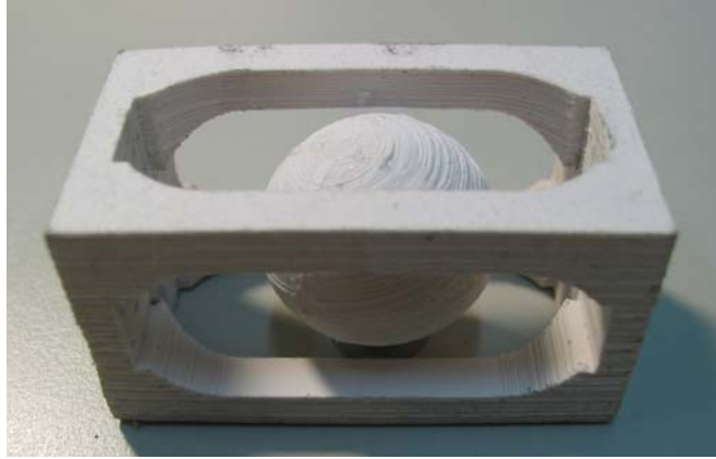
圖 6-3 Bridge-LOM 製程製作之中空球件實體圖[46]
