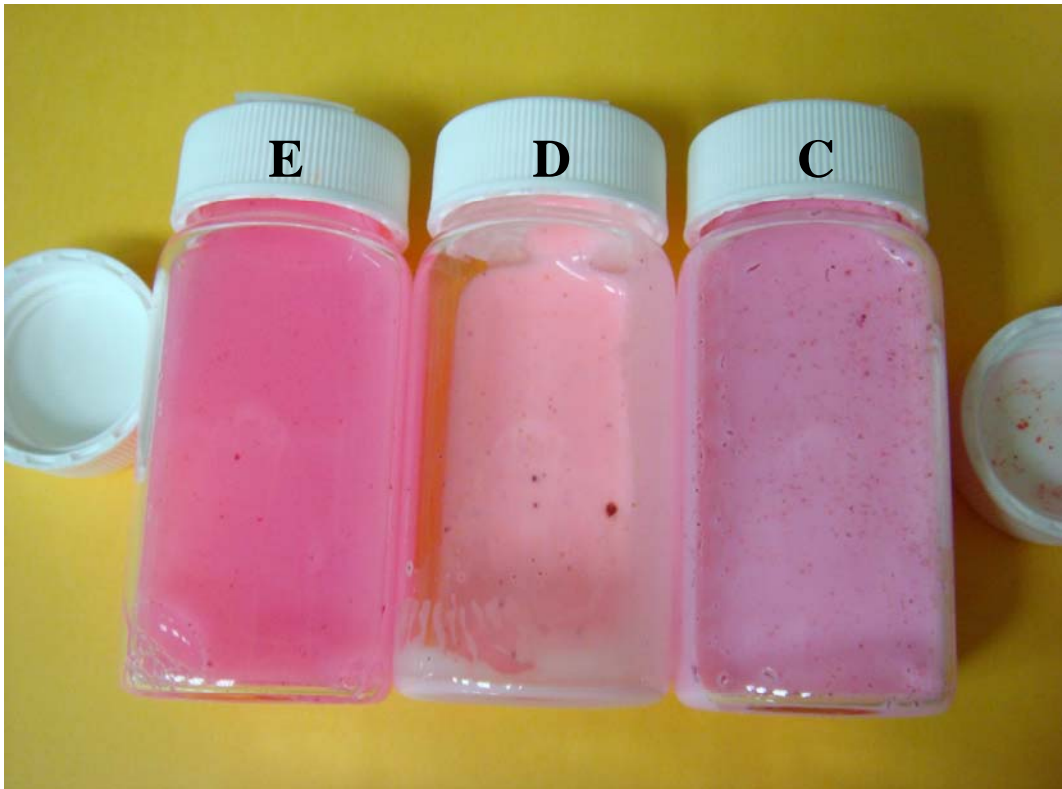
圖 4-4 分層乳液型態之判斷，C：未分層乳液 (O/W 型乳液)，D：分層乳液上層， E：分層乳液下層。
