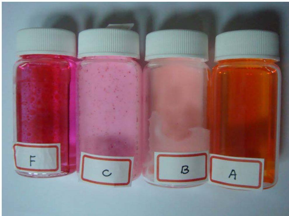
圖 4-3 未分層乳液型態之判斷，A：油/界面活性劑，B：O/S=2，Oil=70% 水 30% (W/O 型乳液)，C：未分層乳液 (O/W 型乳液)，F：水。
