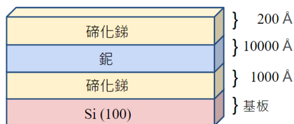
Figure 4.6: \text{Sb}_2\text{Te}_3 / Nb 多層膜樣品示意圖
