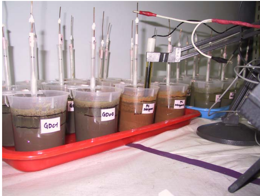
圖四、測定浸水土壤之氧化還原電位。
