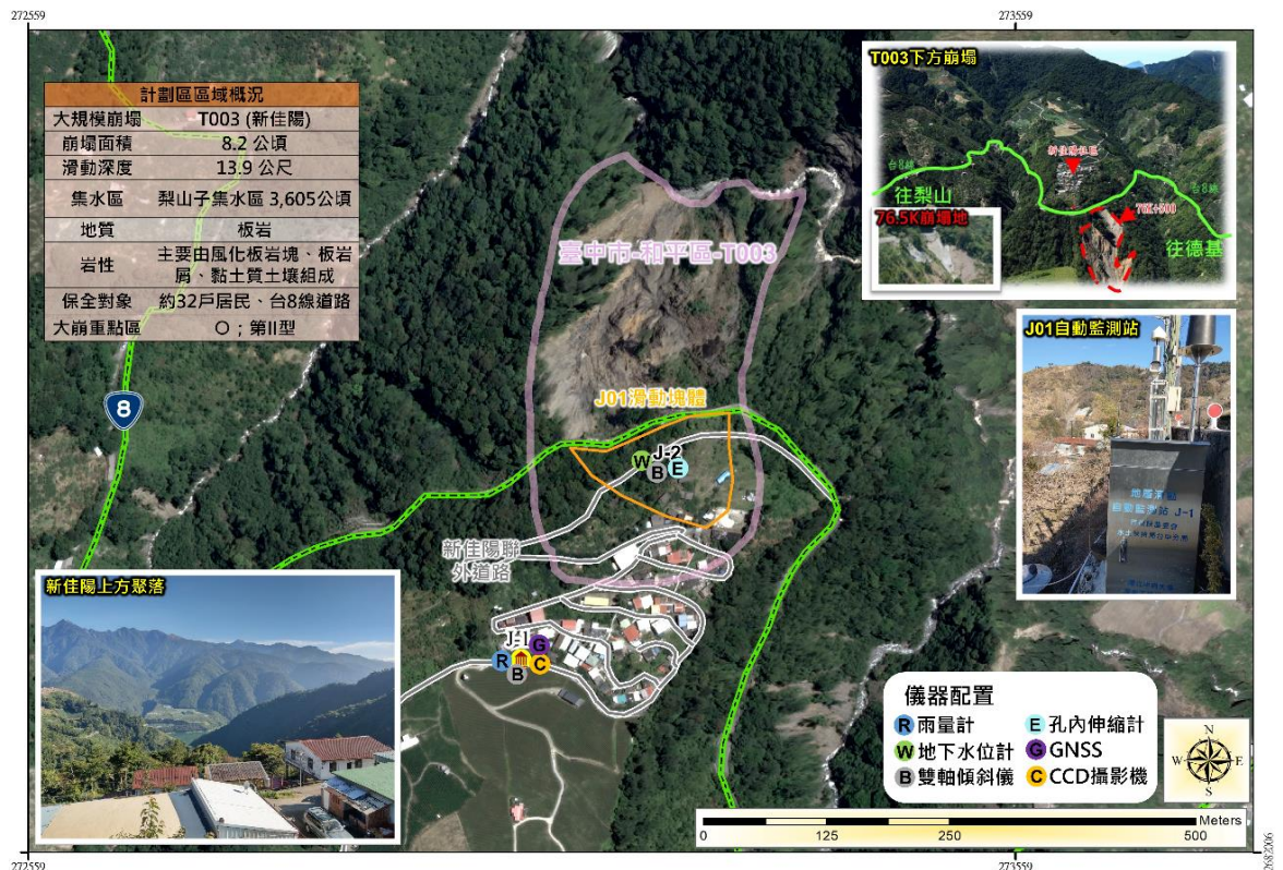
圖 3-4 臺中市-和平區-T003 監測儀器分布圖
