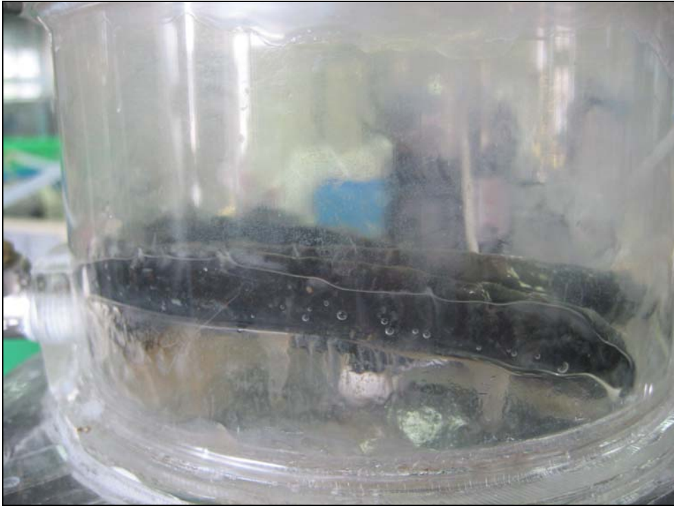
圖 4-15 實驗第 1 天反應槽底部曝氣管
