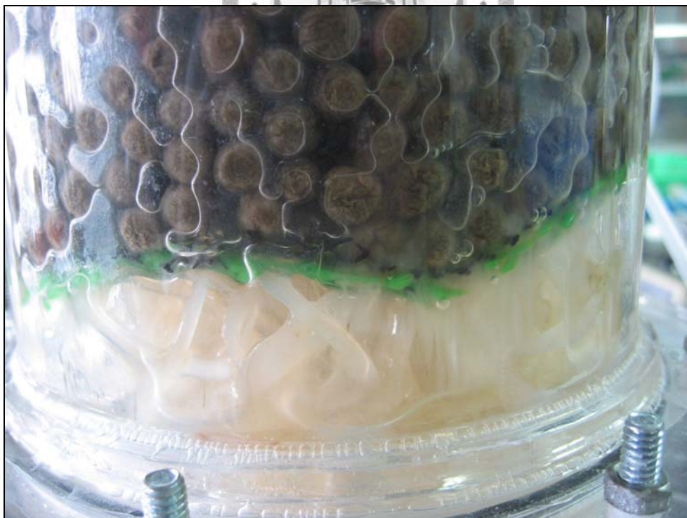
圖 4-18 實驗進行第 7 天反應槽下層填充物生物生長
