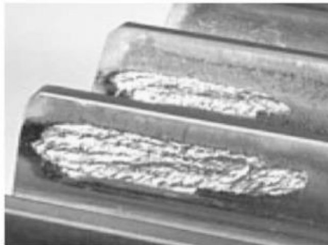
圖 2-8 表面疲勞磨耗形貌[15]
