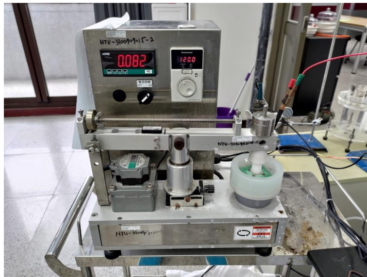
圖 2-13 本研究所使用之磨耗機
