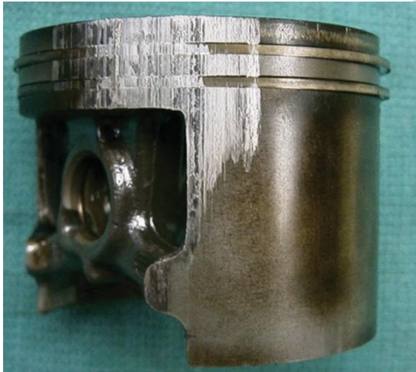
圖 2-4 活塞未正常冷卻造成黏著磨耗[16]
