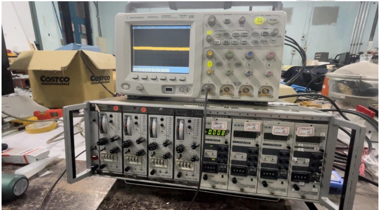
上方：廠牌 AGILENT 型號:DSO5054A 數位儲存示波器
