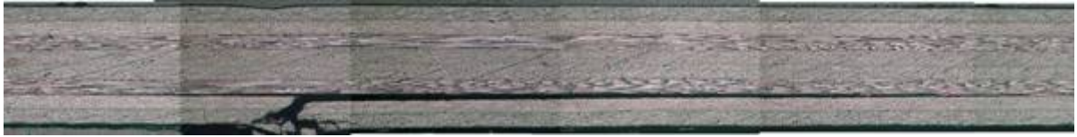
圖 26 炭纖維複材試片經 80cm 高度衝擊之扭轉破壞顯微觀察 B-B 截面。
