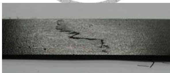
斷裂試片背面扭轉破壞
