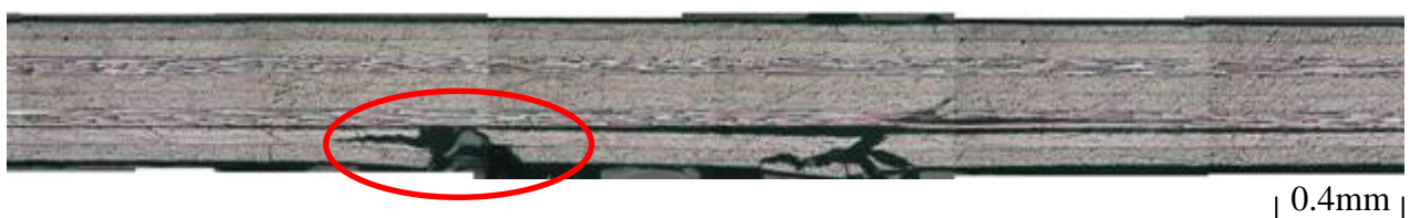
圖 25 炭纖維複材試片經 80cm 高度衝擊之扭轉破壞顯微觀察 A-A 截面。
