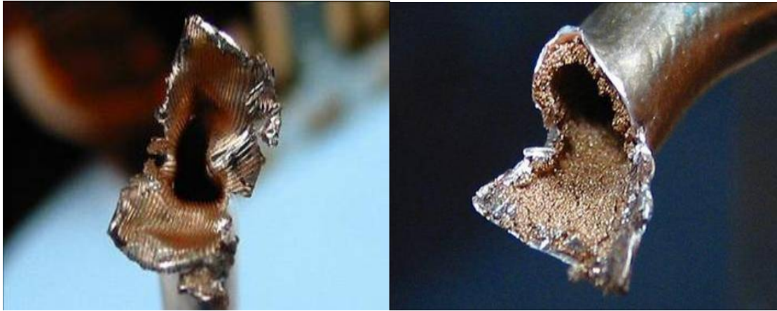
圖 2-3 常見毛細結構（溝槽式、燒結式） [32]
