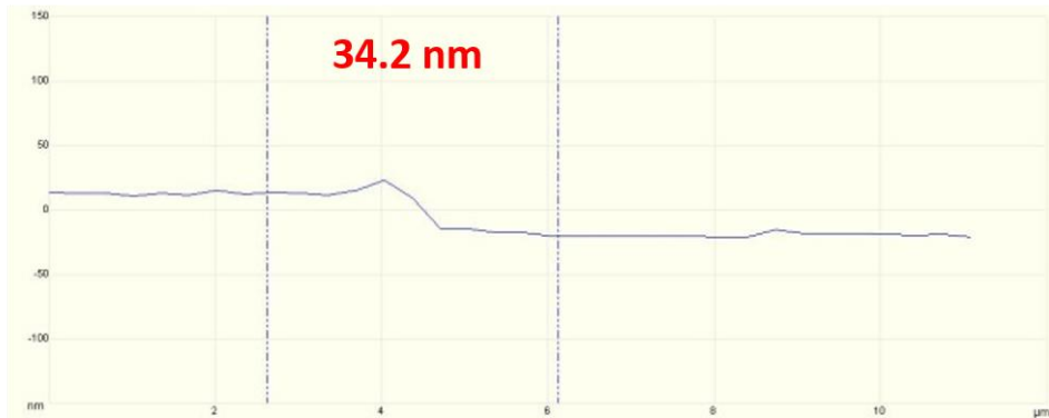
Fig. 9 SnS 2 影像 (a)光學顯微鏡下 SnS 2 (b) AFM 影像 (c-d)分別表示(b)中紅線 1 與紅線 2 得高度分析，我們選用淺藍綠色的 SnS 2 薄片做為通道材料
