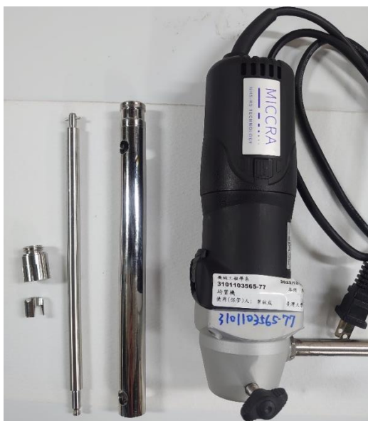
圖 3.7 均質機：(左)各個零件；(右)刀頭特寫
