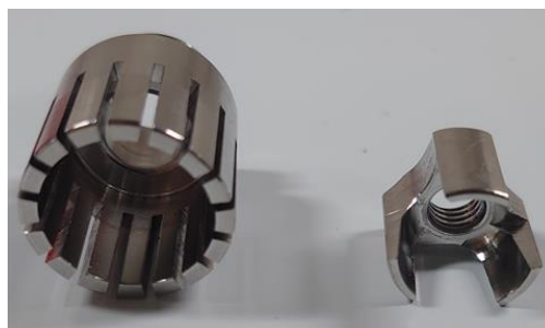
圖 3.7 均質機：(左)各個零件；(右)刀頭特寫
