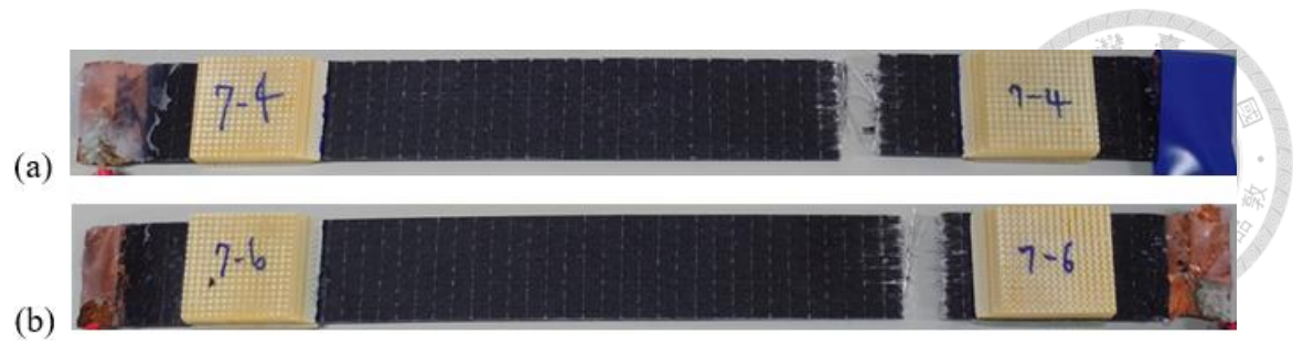
附圖 214 浸泡熱水 4 天試片拉伸破斷外觀：(a)S7N4；(b)S7N6
