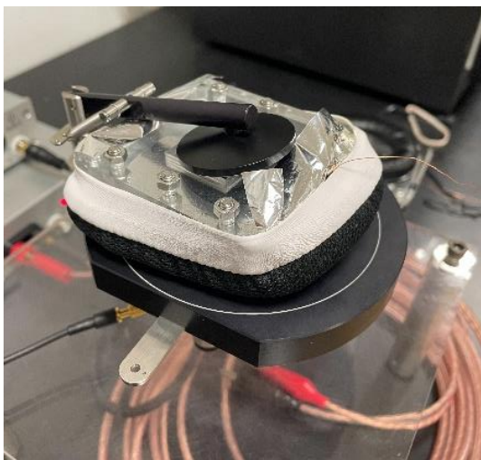
圖 2-10 人工耳實際量測圖
