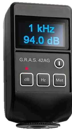
圖 2-9 多功能聲音校準器(G.R.A.S. 42AG)
