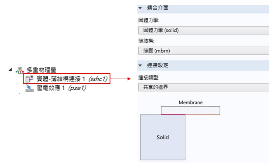
圖 6-4 壓電複合薄膜耦合面設定圖
