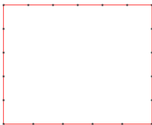
圖 4-2 矩形薄膜邊界節點設置示意圖
