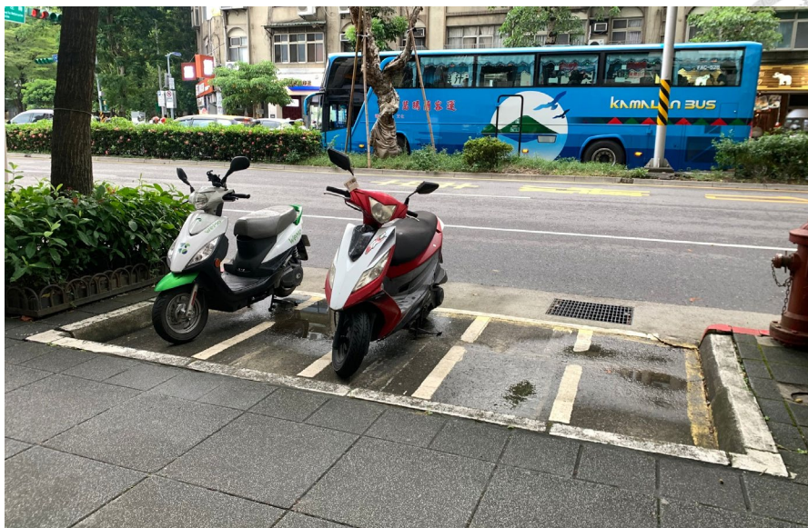
圖 5-11 機慢車停車格挖低設計
