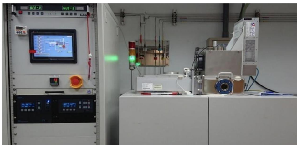
圖 3-1 低損傷電漿系統 (明志科大黃啟賢教授實驗室提供) [49]
