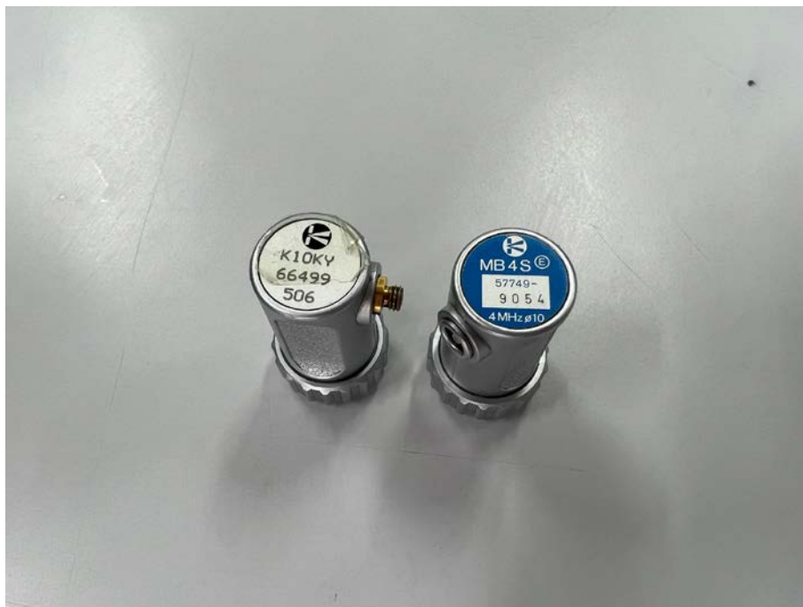
圖 3-39 超音波探頭橫波（左）與縱波（右）
