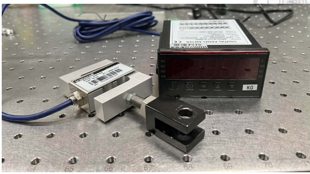
圖 6-14 荷重元 (左) 及其顯示器 (右) 實體圖
