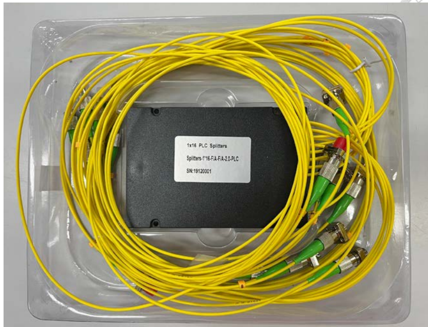
圖 3-21 光耦合器實體圖（一分十六）
