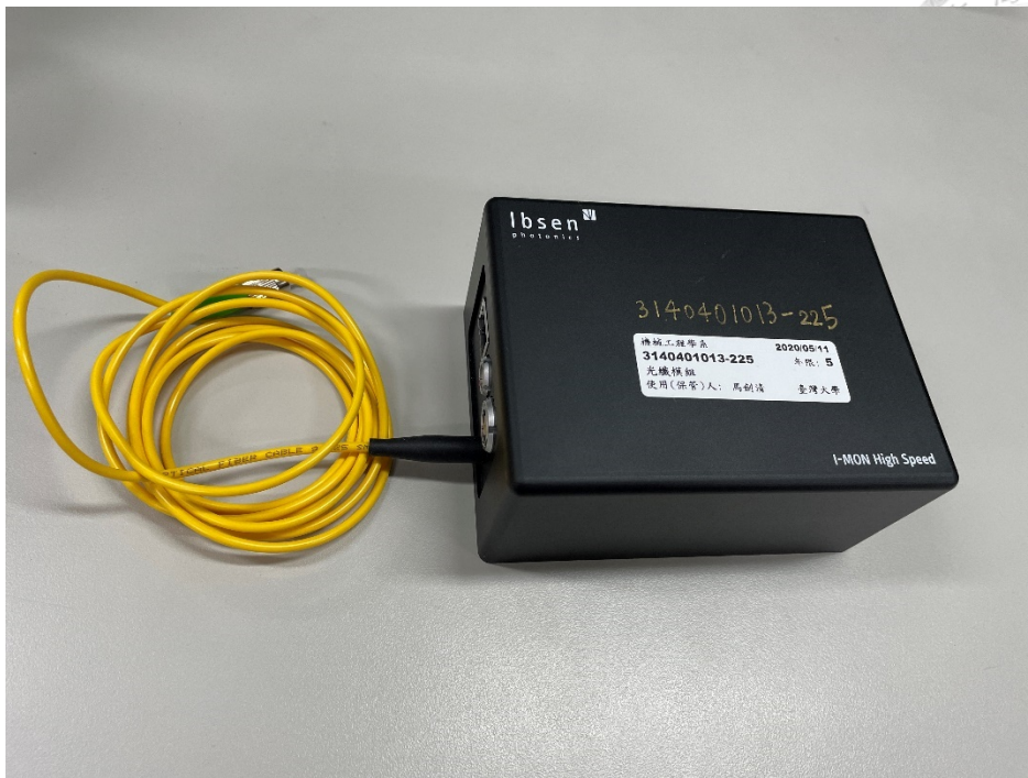
圖 3-25 高速波長解調器 I-MON 256 High Speed 實體圖
