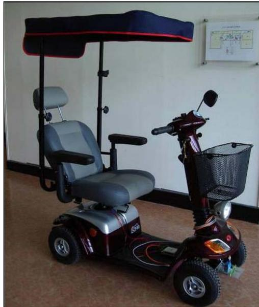
圖 3.5.10 代步車式輕型平坦儀[9]
