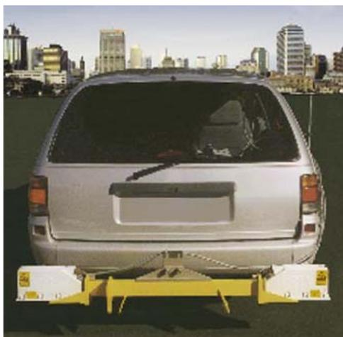
圖 3.5.3 ARRB 雷射平坦儀(後保險桿)[9]
