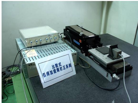
圖3.2 加速度規校正振動平台
