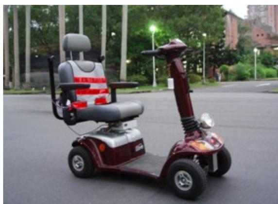
圖2.15 代步車式輕量型平坦儀[7]
