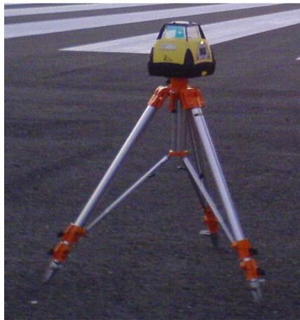
圖2.16 雷射發射器及三角架
