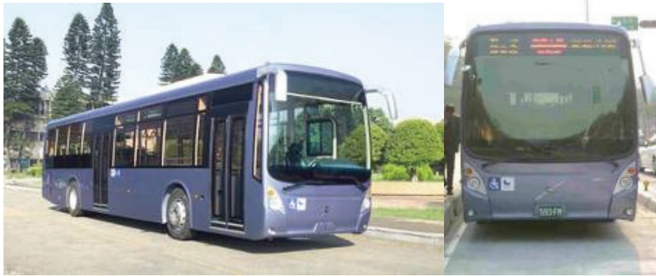
圖 2.5-4 嘉義 BRT 系統所使用之低底盤公車
