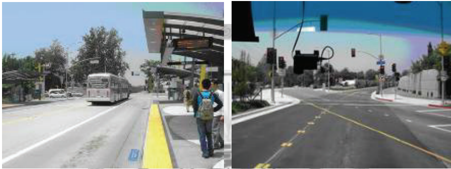
圖 3.2-14 路段專用與路口混合方式車道圖
