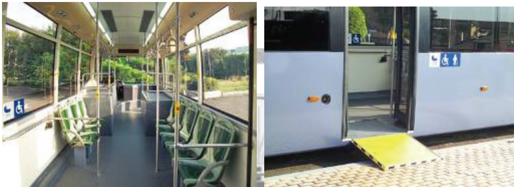
圖 2.5-5 嘉義 BRT 低底盤公車車內空間與設施
