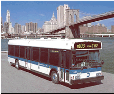
圖 2.3-2 低污染全低底盤柴油公車 (紐約市)
