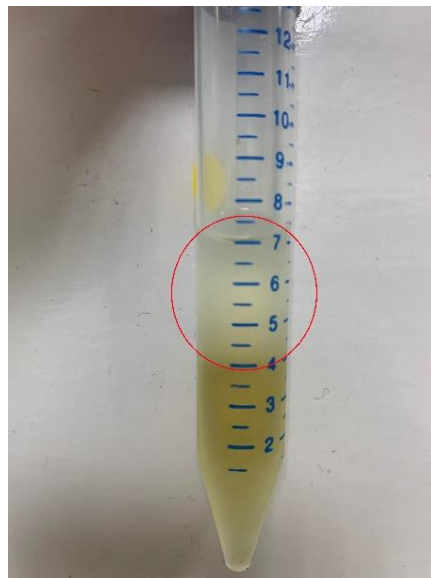
圖十四、萃取乳化現象。以 ethyl acetate 或 MTBE 萃取後，水層與透明有機層之間，存在半透明凝膠狀之難溶物質 (圓圈圈起處)。
