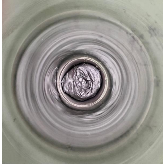
圖 4-7 在石英管內未噴出之 TiNi 材料
