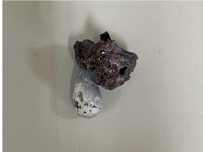
圖 4-6 與石英管反應而流出之 TiNi 材料
