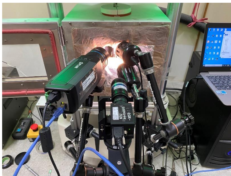
圖 3-7 超彈性與彈熱效應實驗設備架設方式
