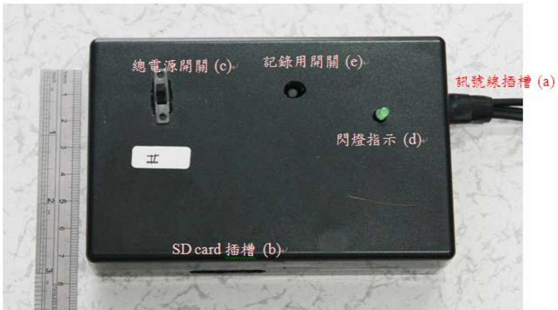
圖 16 自行研發的生理訊號分析儀
