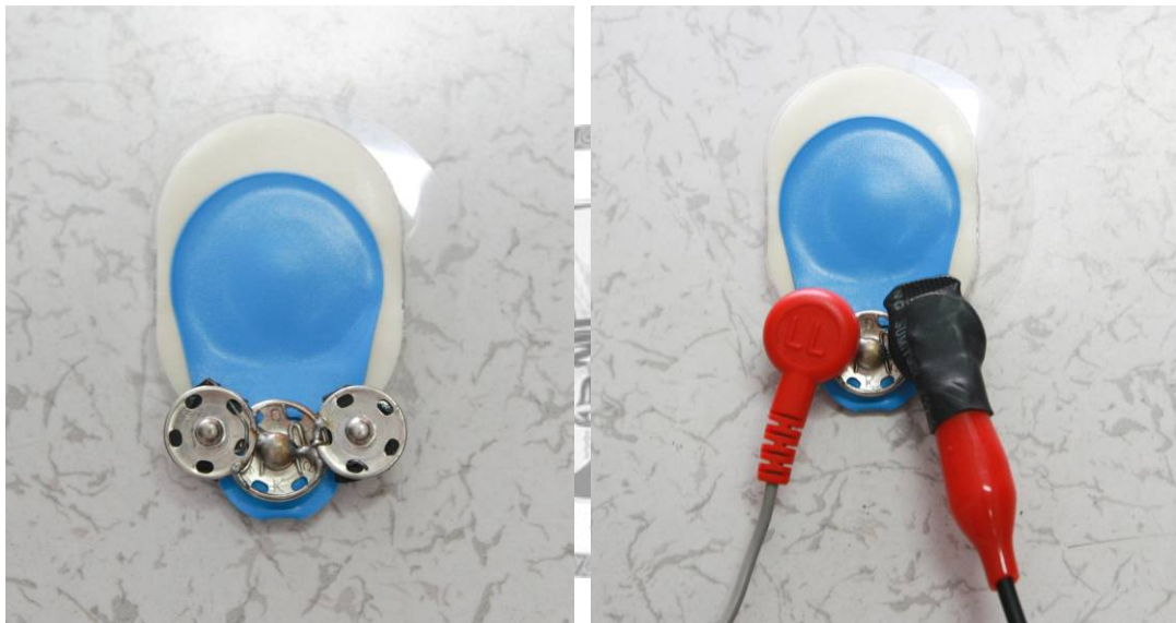
圖 42 多接點電極貼片改良
