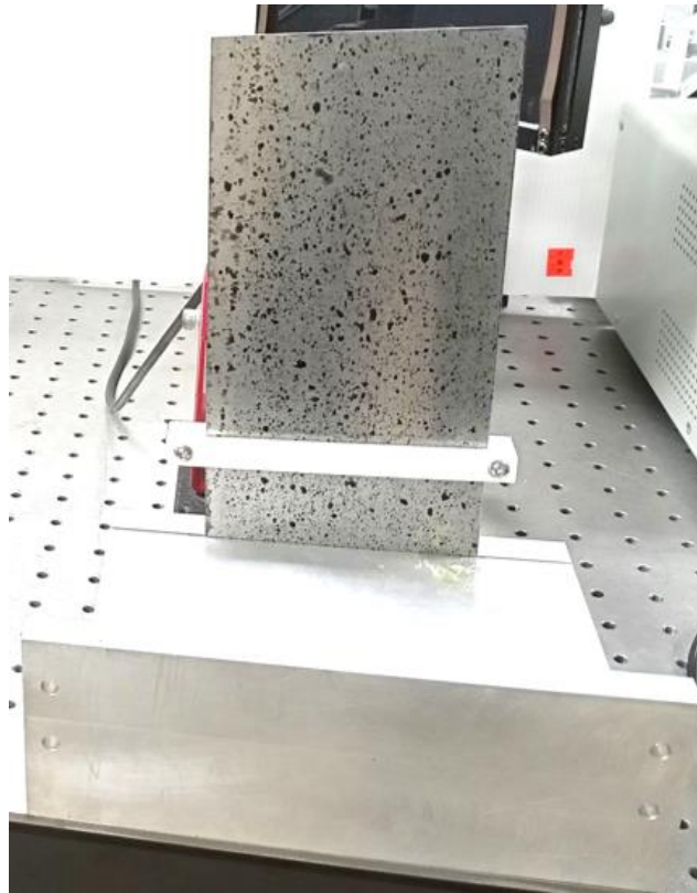
圖 5-1 懸臂薄板架設圖
