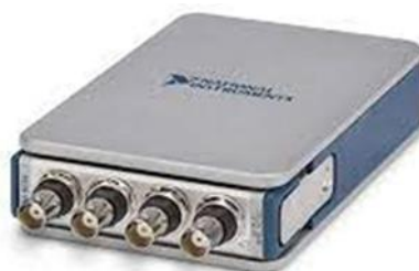
圖 2-28 NI-9234 資料擷取系統
