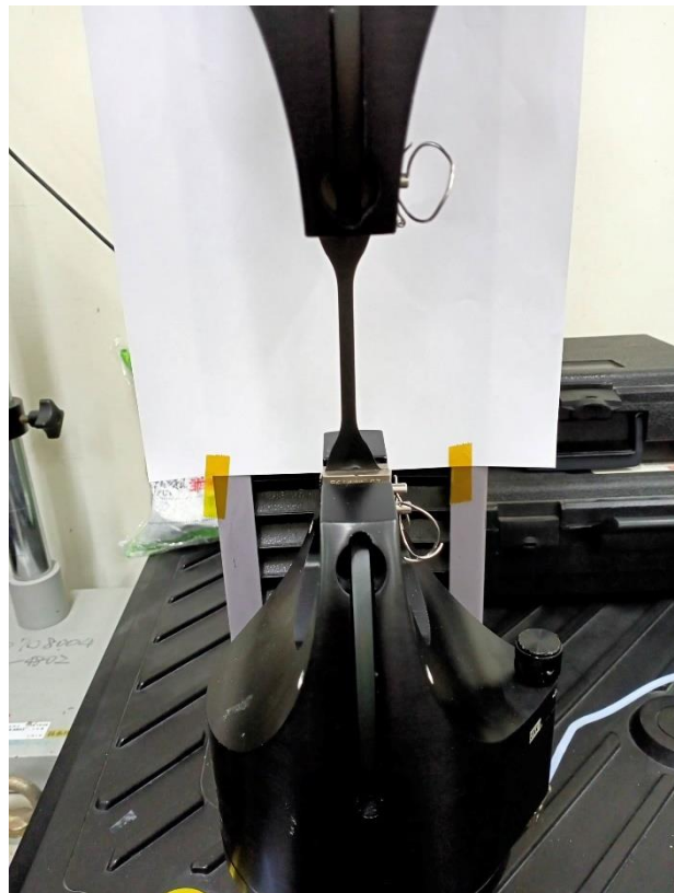
圖 5-20 夾持試片示意圖
