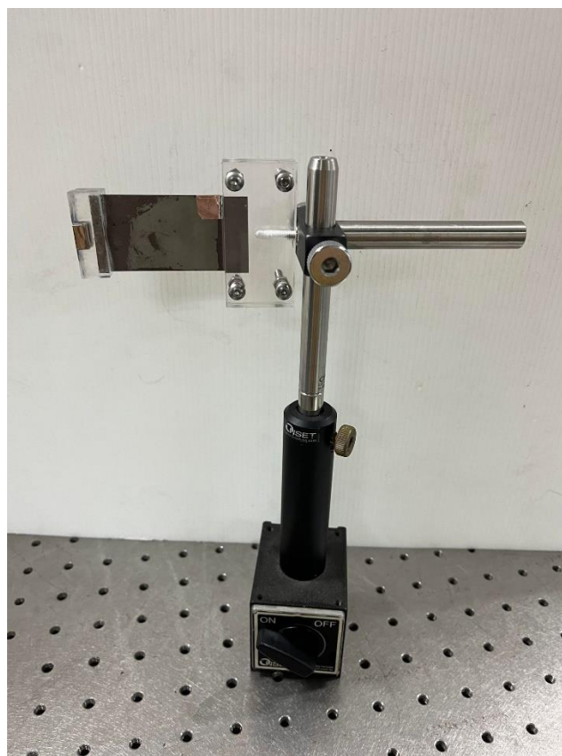
圖 3-33 壓電陶瓷雙晶片附加磁鐵之實體試片
