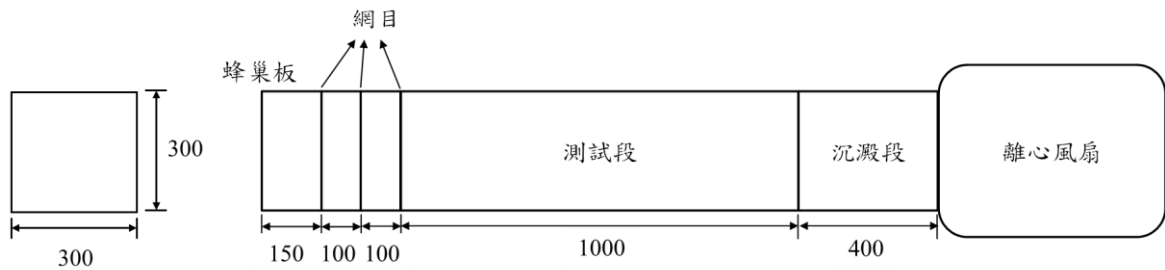
圖 2-7 風洞尺寸示意圖 (mm)
