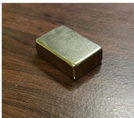
圖 3-30 鈦鐵硼磁鐵 30 \times 20 \times 10 \text{ (mm}^3\text{)}
