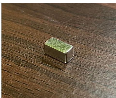
圖 3-29 鈦鐵硼磁鐵 10 \times 5 \times 5 \text{ (mm}^3\text{)}
