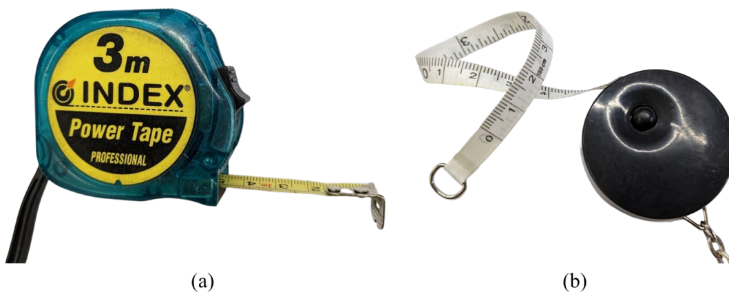
圖 3-15 捲尺：(a)量測果實位置之鋼捲尺；(b) 量測果實圓周之軟捲尺
