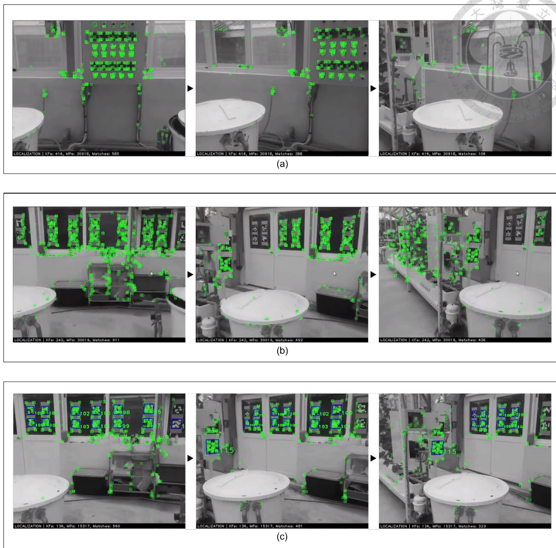
圖 4-10 無人機轉彎定位效果分析：(a)在無 aruco 區域使用 ORB-SLAM2；
