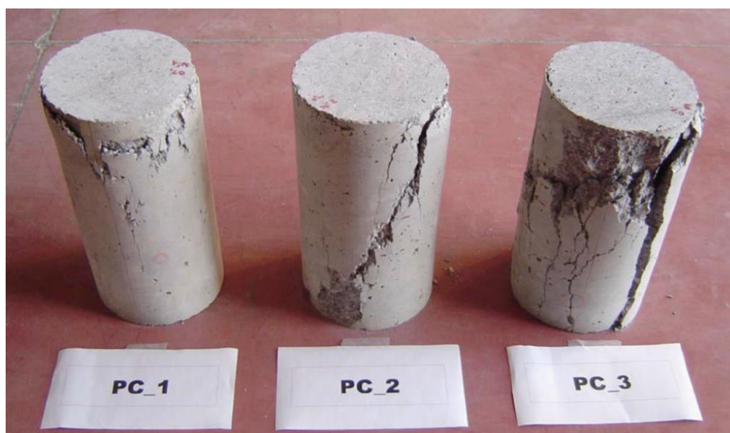
圖 2-9 高強度混凝土圓柱試體之破壞情形 (Bencardino et al. 2008)
