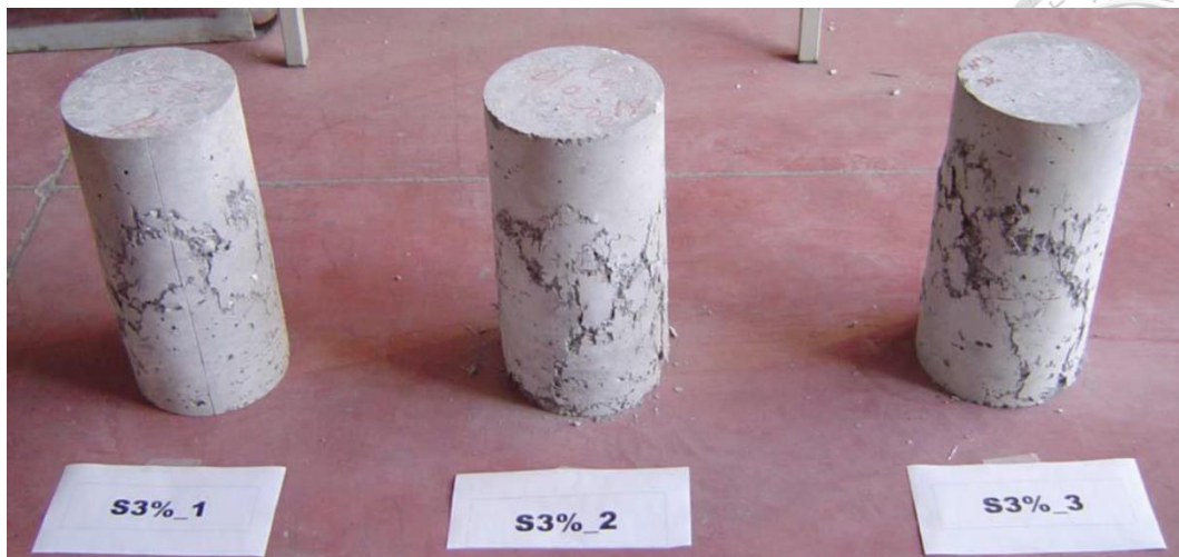
圖 2-10 高強度混凝土圓柱破壞情形—添加 3%體積取代率下
