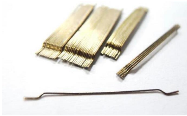
圖 4-1 高拉力端鈎型鋼纖維示意圖
