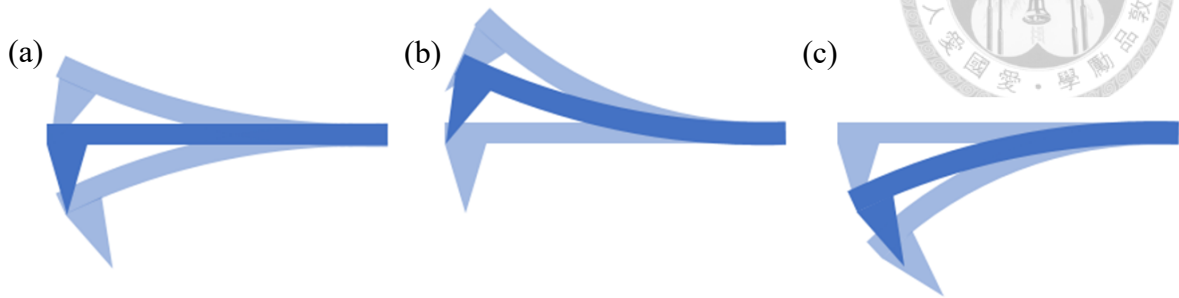
圖 4.6 探針在(a)正常情況(b)受到排斥力(c)受到吸引力時激振情形示意圖。
