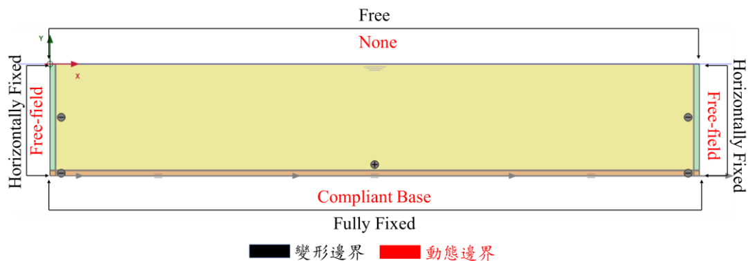
圖 4.25. 數值模型邊界條件（變形和動態）設定示意圖
