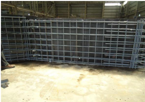
圖 65 預鑄樓梯結構配筋照片 (資料來源:參 18)
