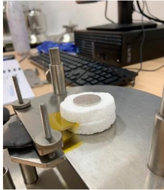
圖 3-11 纖維氣凝膠熱導係數之量測
