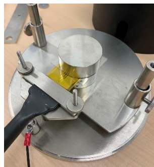
圖 3-13 S4VP 熱導係數之量測
