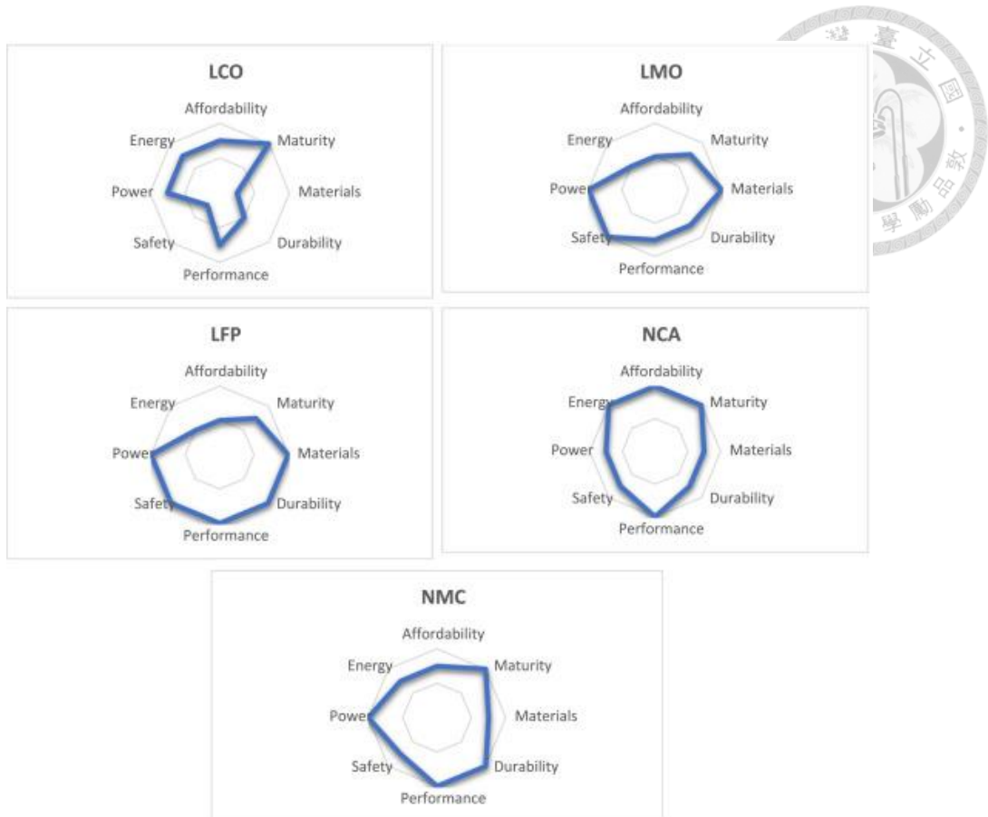
圖 2.5 不同正極材料之鋰電池特性(Wen et al. , 2012)
