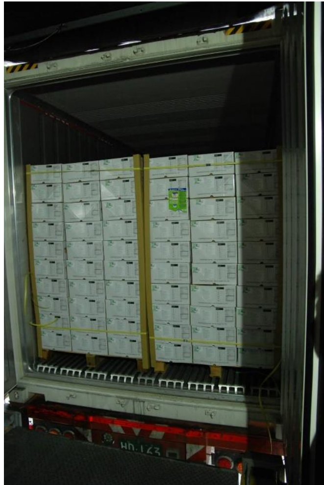
圖 4-6 USB 溫度計(綠色方形物體)安裝於貨櫃尾端
