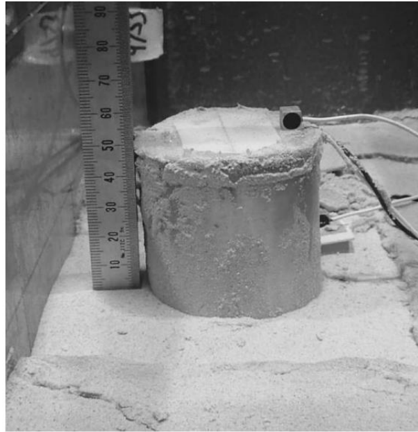
圖 2.28 模型人孔上浮 (Tobita et al., 2011)
