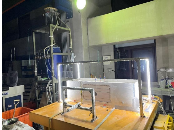
圖 3.9 除氣水裝置與振動台
