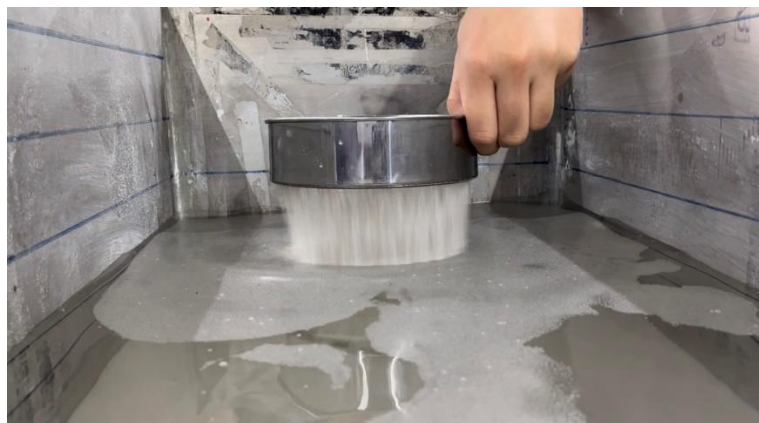
圖 3.25 利用乾砂水中沉降法填製試體
