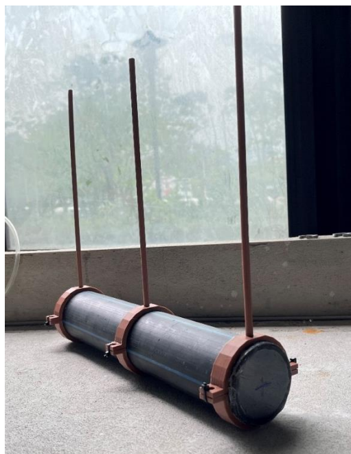
圖 3. 21 管線模型及三組 3D 列印之標桿
