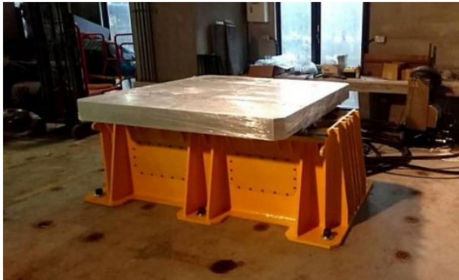
圖 3.19 單軸向振動台
