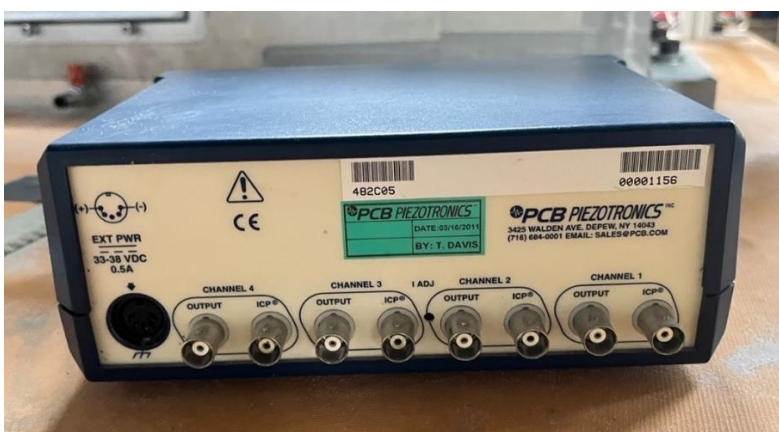
圖 3.12 加速度訊號調節器
