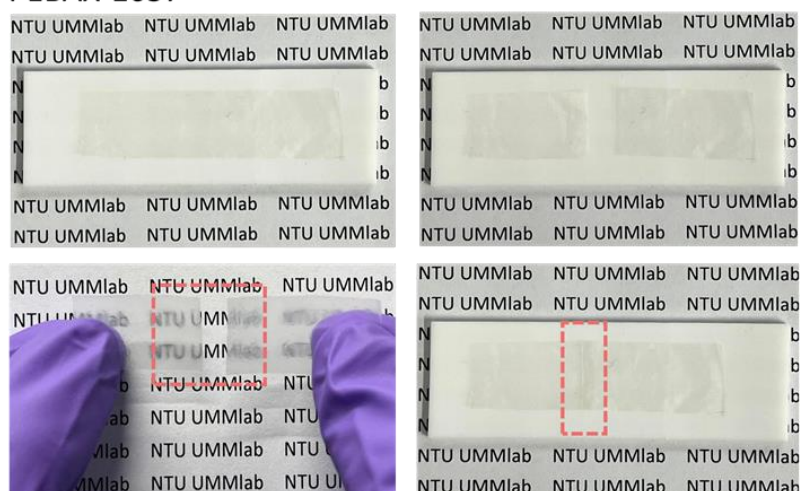
圖 3-7 檢測高分子薄膜機械性質自修復的流程圖[82]。
