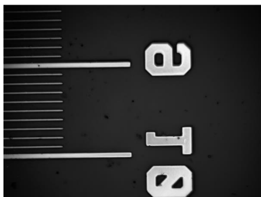
圖 2.21 橫向解析度量測結果(a)解析度測試片量測影像 (b)橫向訊號強度分布。
