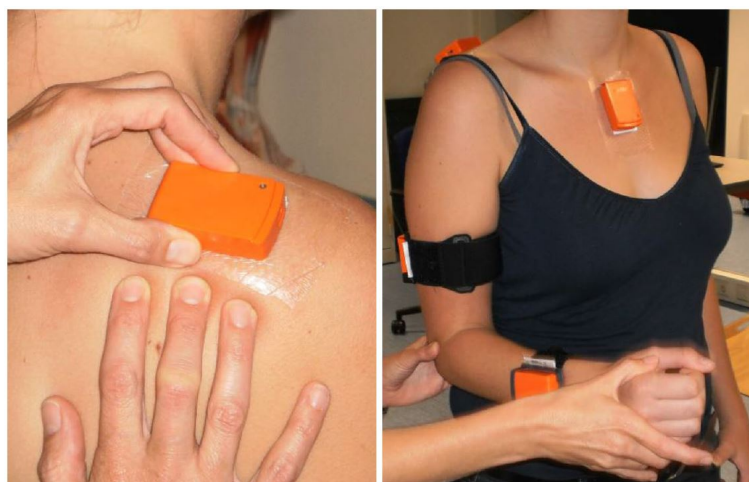
圖 2.2: 基於 IMU 之肩胛骨運動學量測應用 [36]
