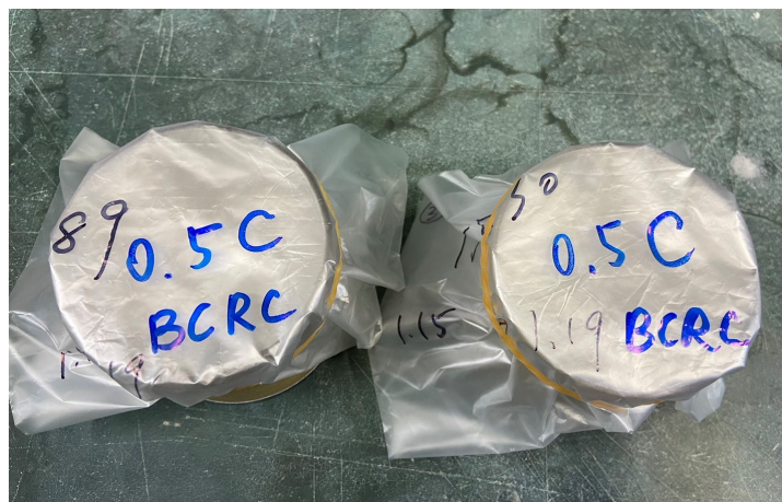
Figure 3.31: MICP 改良試體封上塑膠袋進行養護
