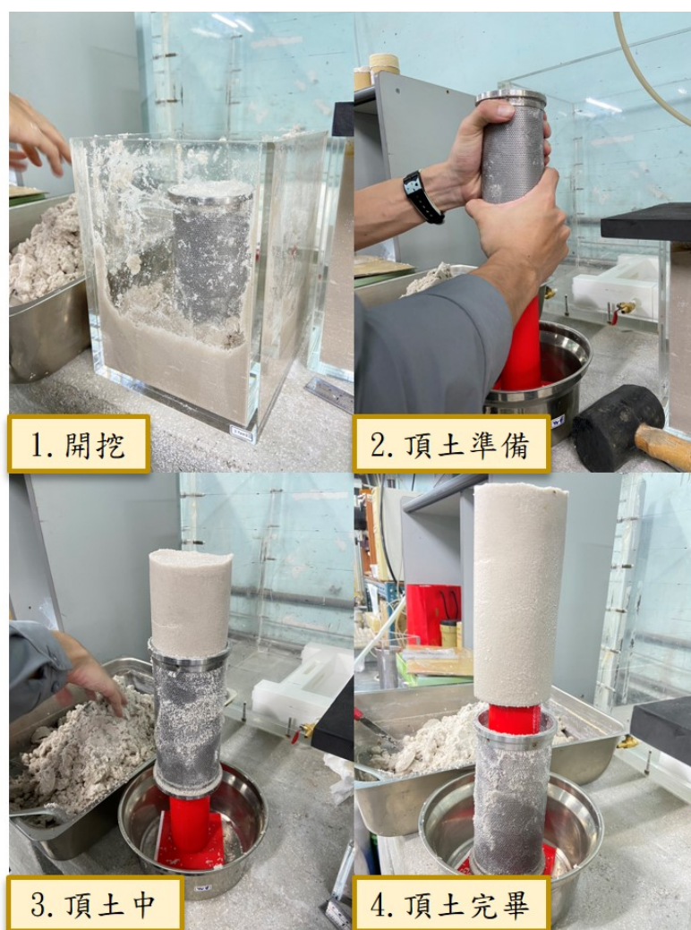
Figure 3.34: 靜態三軸壓密排水剪切試驗之 MICP 改良試體準備
