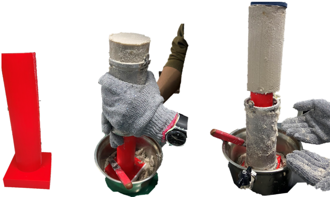
Figure 3.24: 以頂土器取樣示意圖
