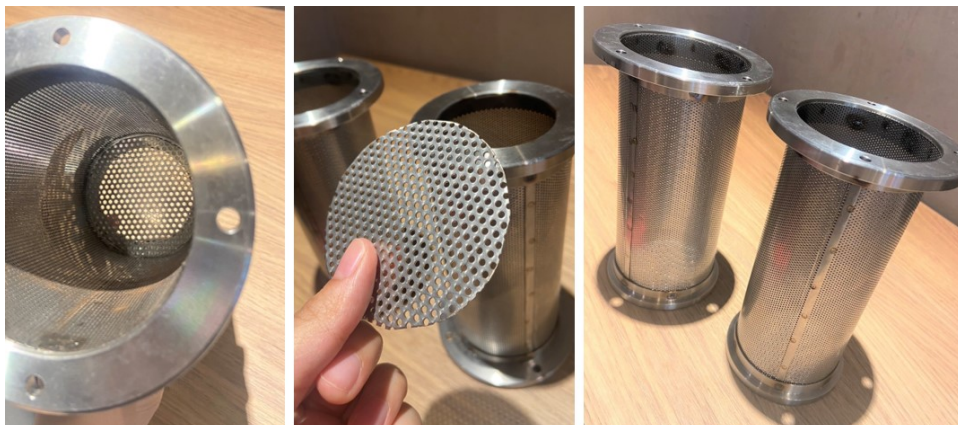
Figure 3.18: 取樣器 A 初始設計及底部洞洞板
