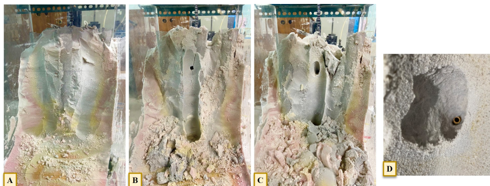
Figure 4.19: 加壓噴液產生滲流孔洞 (A: 噴口處正前方之兩取樣器尚未取出; B: 取出外側之取樣器後; C: 取出內側之取樣器後; D: 滲流孔洞與澆灌噴口放大圖)
