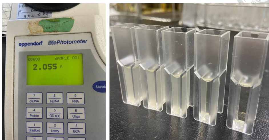
Figure 3.7: 以可見光分光光譜儀檢測菌液之 OD_{600}
