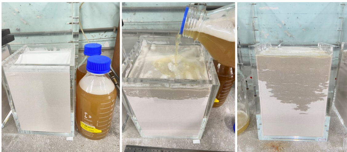
Figure 3.44: 表面滲透之小型砂箱試驗改良液澆灌
