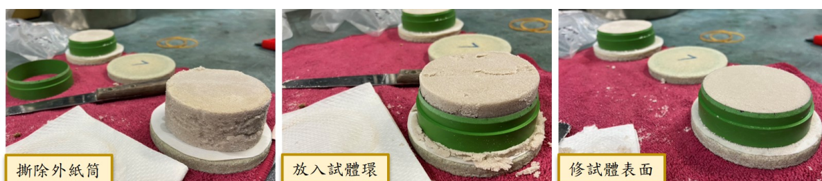
Figure 3.33: 壓力鍋之 MICP 改良試體修整準備
