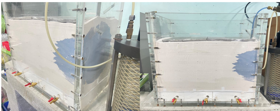
Figure 3.46: 200\text{ kPa} 加壓染色水於乾砂之滲透情形 (藍色)
