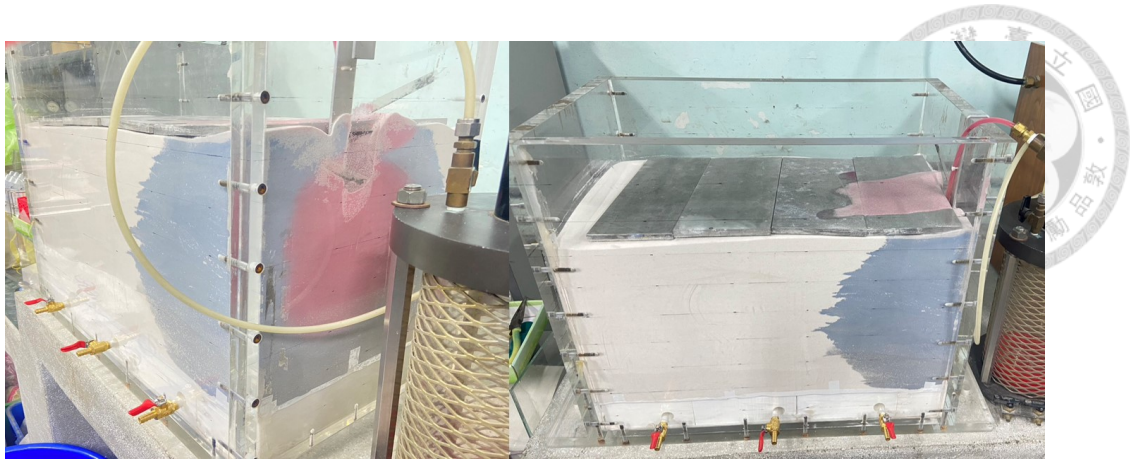
Figure 3.47: 350 kPa 加壓染色水於乾砂中發生砂湧 (紅色)
