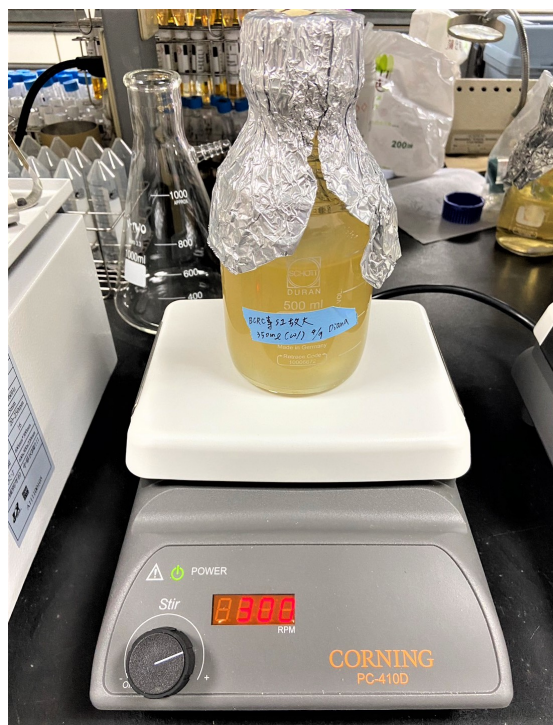
Figure 3.63: 以磁石攪拌機培養菌液 (轉速 360 RPM，進行 24 小時)
