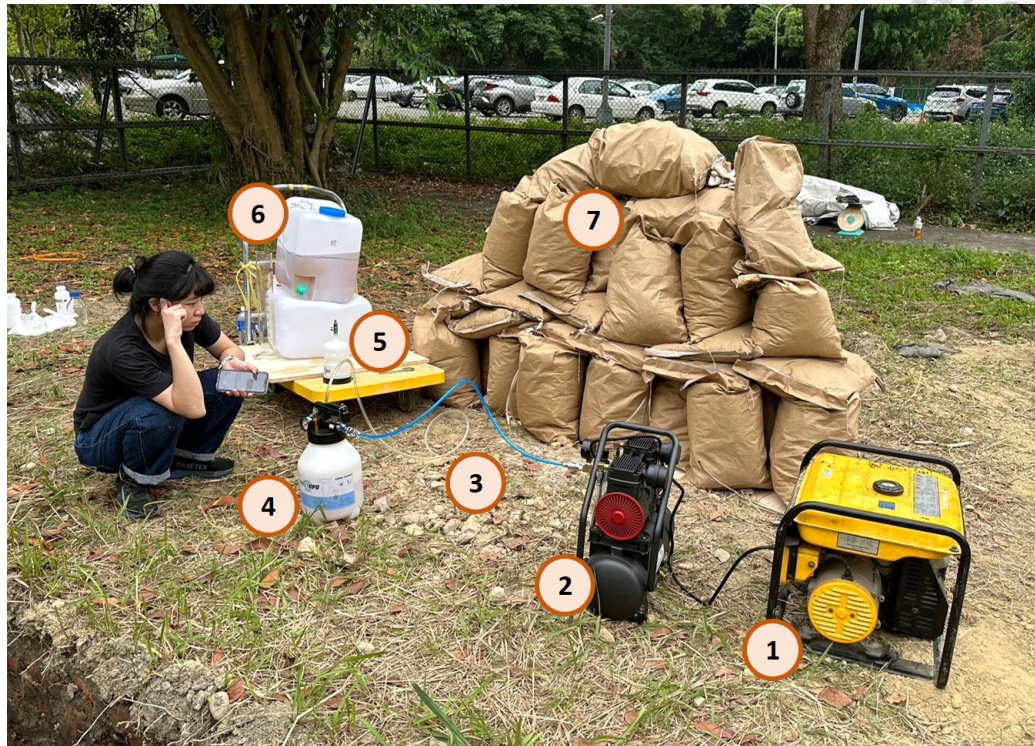
Figure 3.72: 側向加壓滲透之現地試驗配置圖
