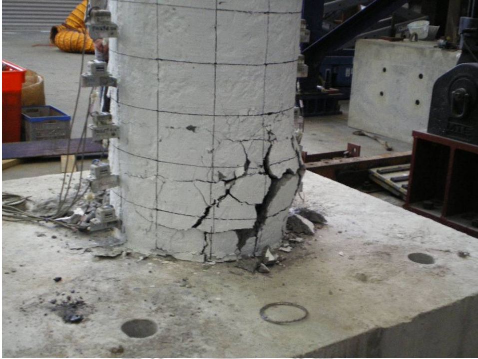
圖 4.9 試體 B 擬動態試驗後之南側柱底照片 (TCU102 真實地震力, 326gal)
