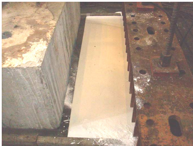
圖 3.15 避免合成橡膠墊滑動之石膏
