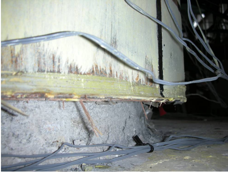
圖 4.33 試體 D 擬動態試驗後之南側柱底照片 (TCU102 設計地震力, 326 gal)
