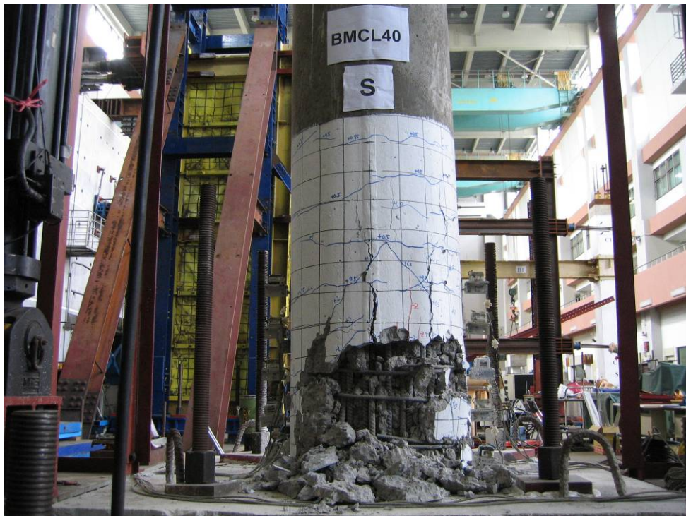
圖 4.1 試體 A 反覆載重試驗 (5%側移率) 後之南側柱底照片
