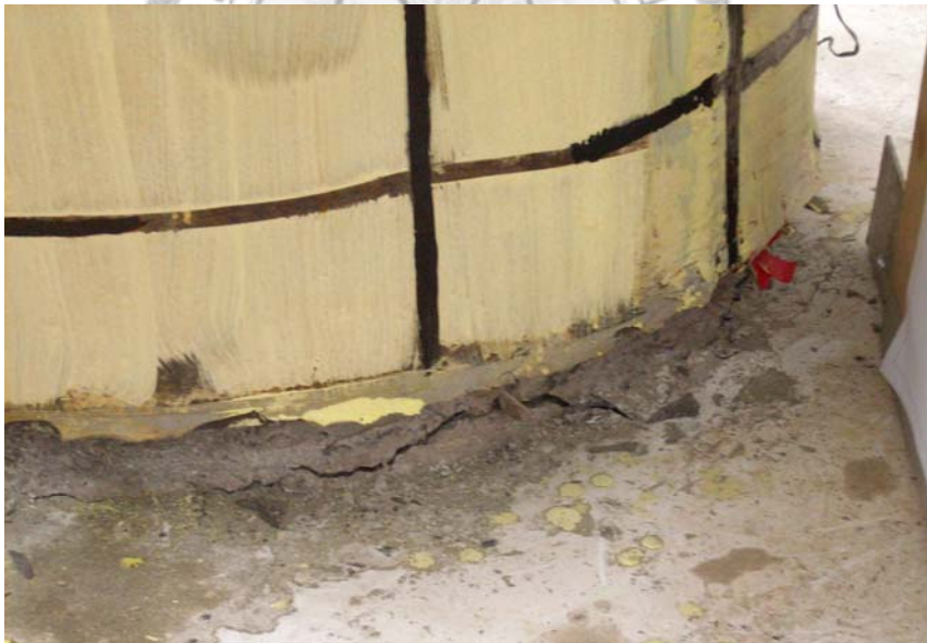
圖 4.34 試體 D 擬動態試驗後之北側柱底照片 (TCU102 設計地震力, 326 gal)
