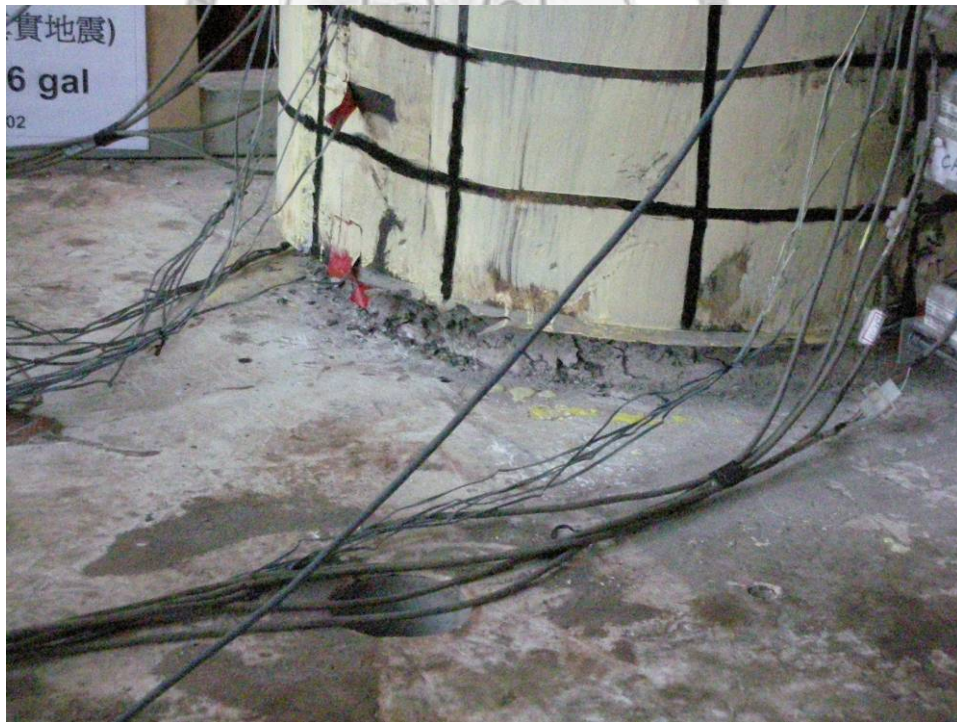
圖 4.40 試體 D 擬動態試驗後之北側柱底照片 (TCU102 真實地震力, 326 gal)
