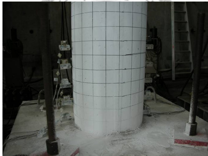
圖 3.23 傳統試驗未補強試體之施力側向側視圖 (XZ 平面), 單位: mm
