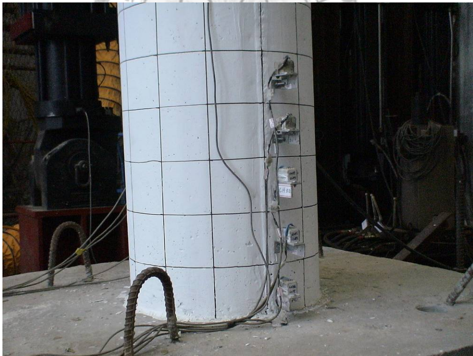
圖 4.15 試體 C 擬動態試驗後之北側柱底照片 (TCU102 設計地震力, 326 gal)
