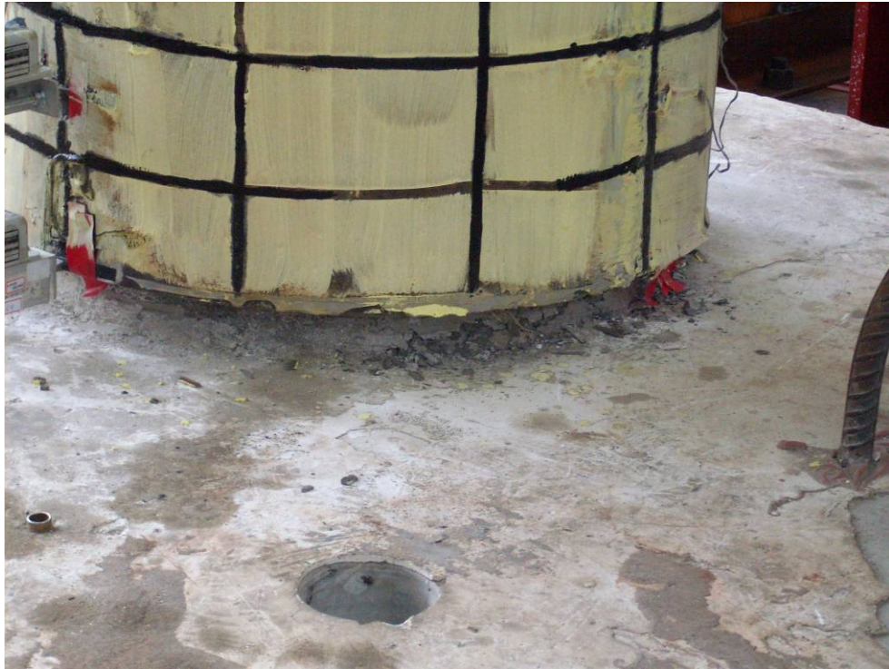
圖 4.39 試體 D 擬動態試驗後之南側柱底照片 (TCU102 真實地震力, 326 gal)
