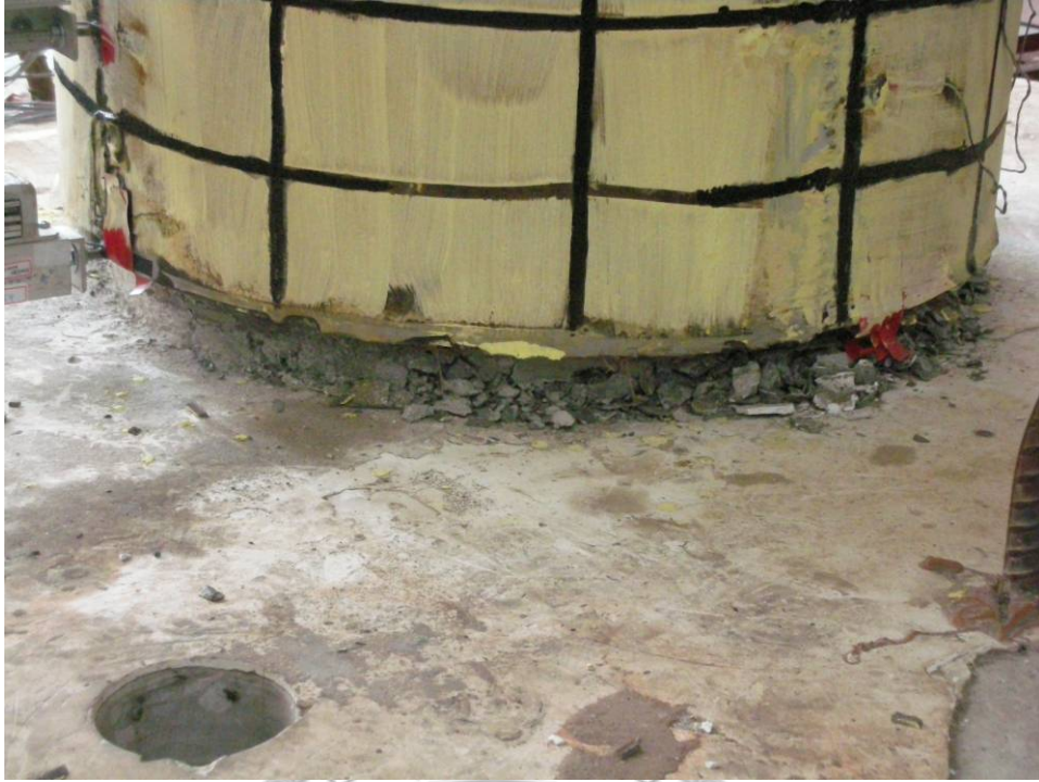
圖 4.44 試體 D 反覆試驗後之南側柱底照片
