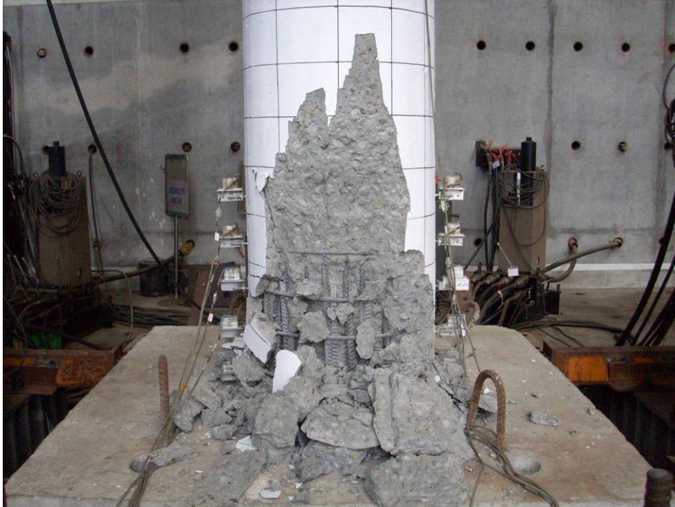
圖 4.21 試體 C 反覆載重試驗（6%側移率）後之北側柱底照片
