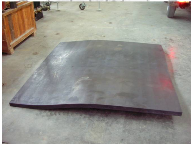
圖 3.10 模擬基礎底土壤之合成橡膠墊
