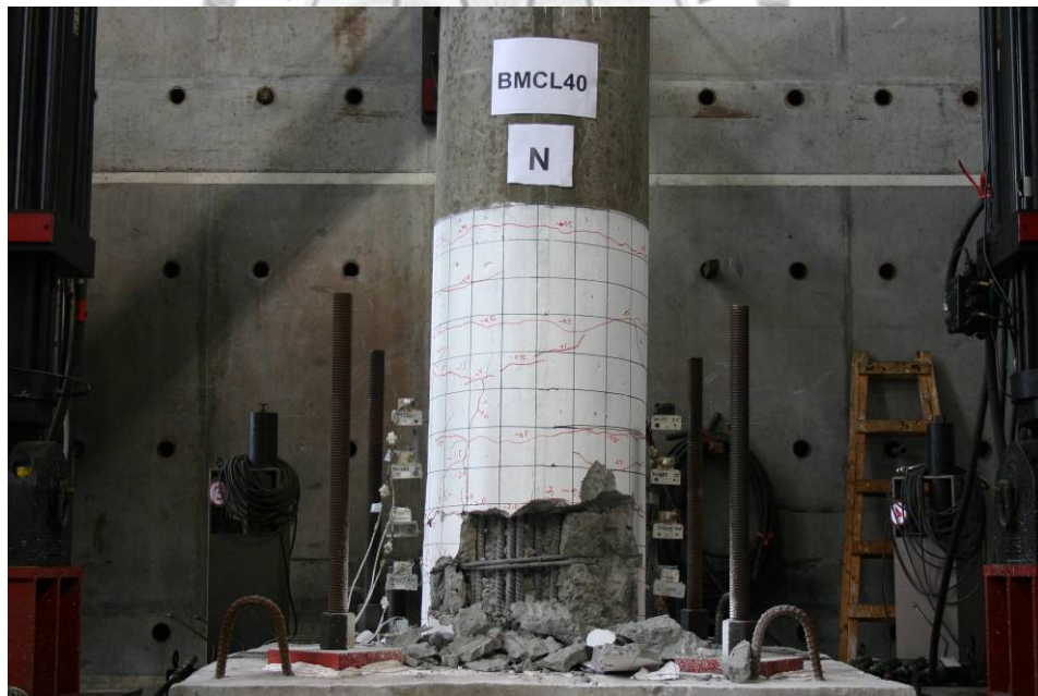
圖 4.2 試體 A 反覆載重試驗 (5%側移率) 後之北側柱底照片
