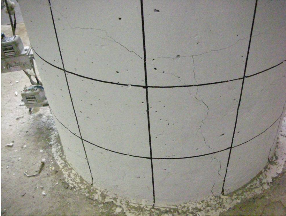
圖 4.14 試體 C 擬動態試驗後之南側柱底照片 (TCU102 設計地震力, 326 gal)
